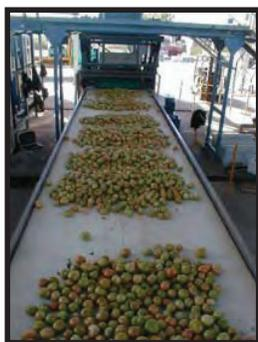
Esto es importante ya que se requiere que el fruto gire y se cepille conforme se aplica el agua de los aspersores y permita un lavado y desinfección eficiente.
